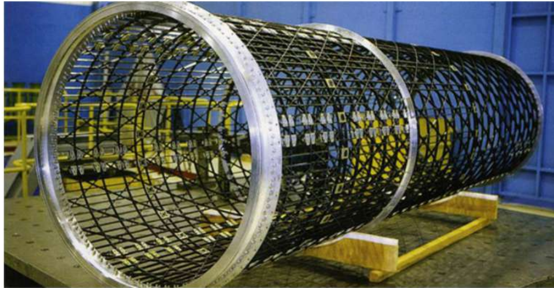
Figura 2.3: Esempio di struttura lattice di un guscio cilindrico
