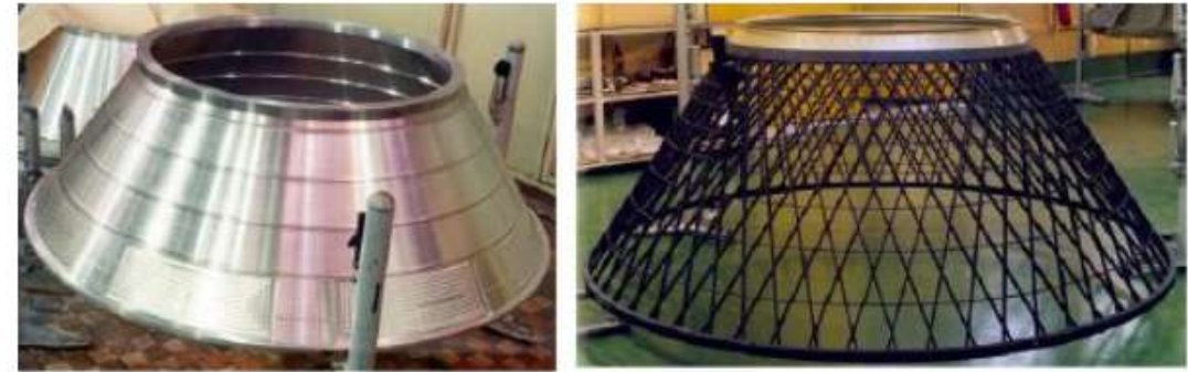
Figura 2.10: Adattatore di carico utile metallico ed in composito a griglia
