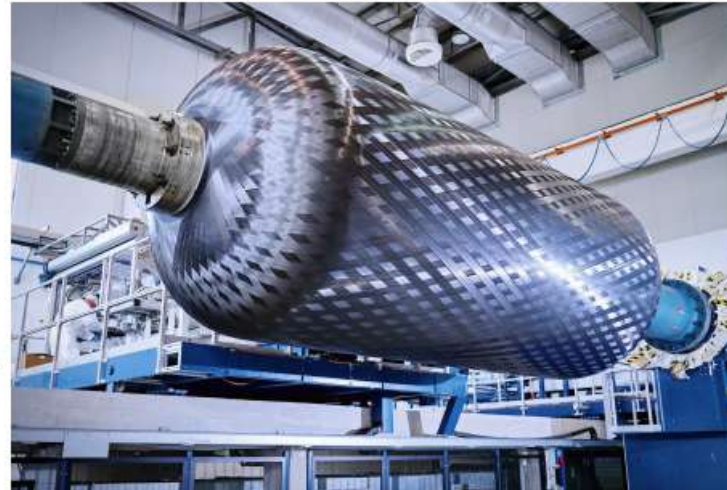
Figura 2.5: Esempio di componente ottenuto con filament winding
